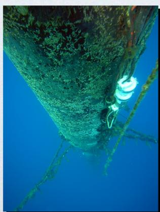
**Lungo il corpo boa, alle profondità di 0, 6, 12, 20, 28 e 36 metri, sono immersi degli strumenti per le misure di tipo oceanografico: temperatura, salinità, torbidità, ossigeno disciolto e fluorescenza.**
