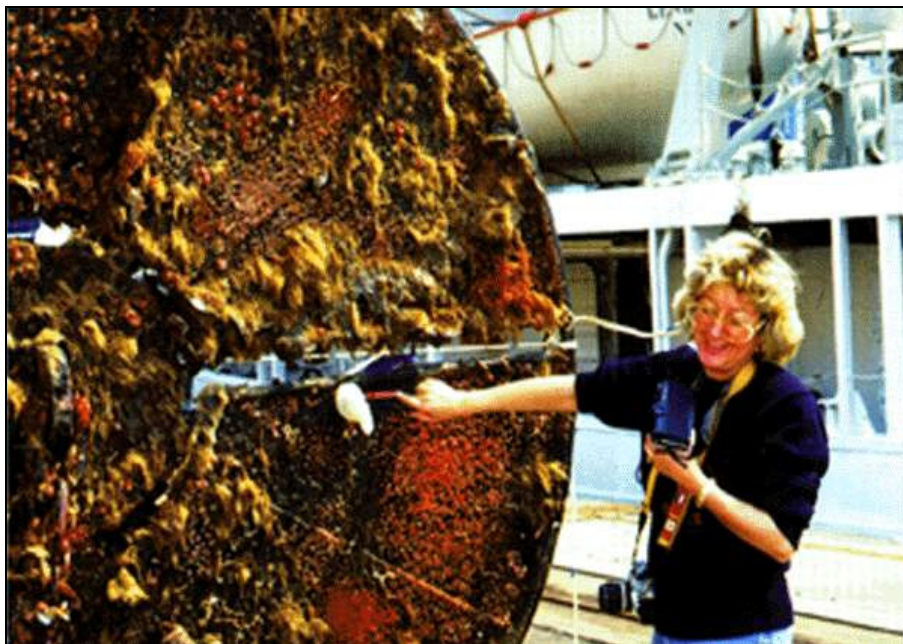
Fig. 11 - Osservazioni effettuate in banchina in occasione del recupero della boa, avvenuto il 15/4/91, dopo 52 mesi di permanenza in mare. E' chiaramente apprezzabile l'insediamento presente sulla faccia inferiore del disco di smorzamento alla profondità di 38m.
